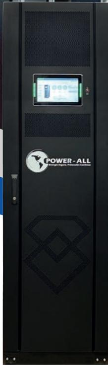
El PA MPP6S-05100LV es un UPS trifásico de tecnología On-Line Doble conversión, escalable con módulos intercambiables “en caliente”, con capacidad de 20 a 100KVA/KW. Cuenta con tecnología de inversor de tres niveles mediante IGBT’s y con DSP, este equipo ofrece la mejor combinación en confiabilidad y flexibilidad.
